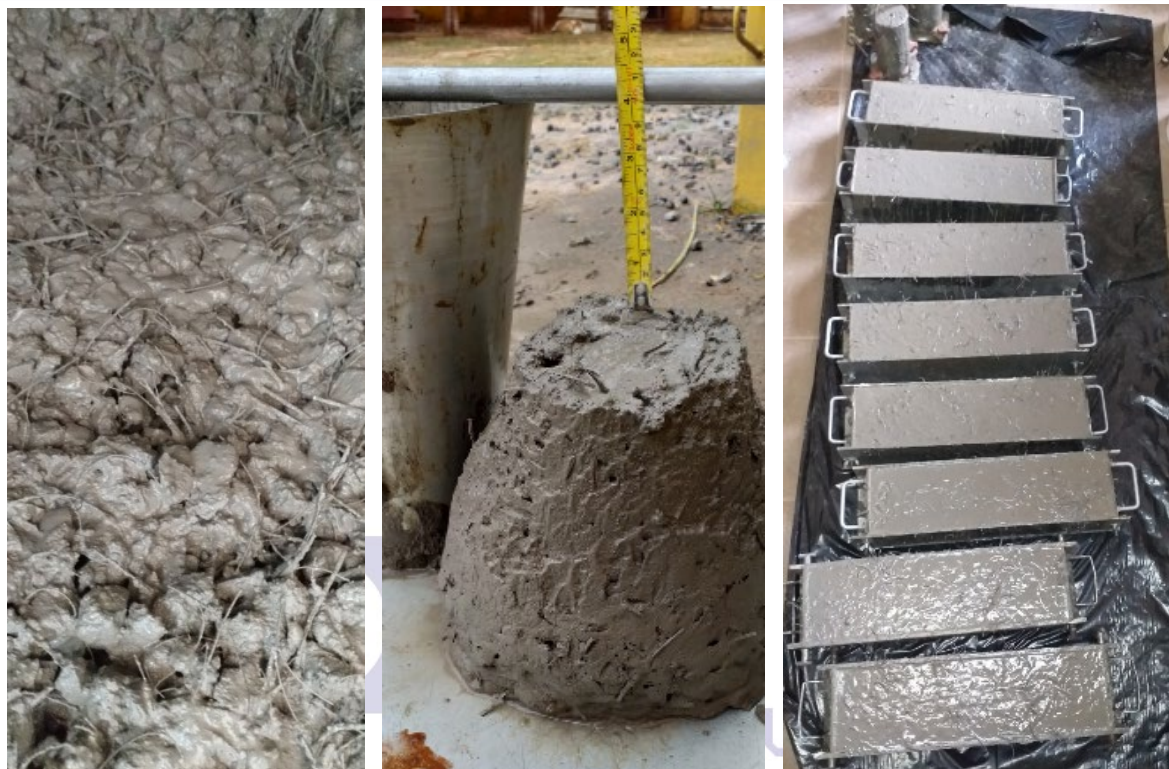
Imagens 5, 6 e 7 – Concreto com fibras (esq), abatimento do tronco de cone (Slump test) e corpos de prova moldados. (dir).
