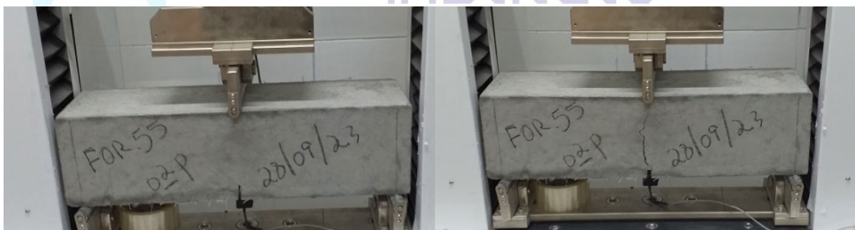
Imagens 7 e 8 – Análise do desempenho do concreto reforçado com fibras à tração na flexão – CMOD. Corpo de prova FOR-55-02P antes e depois do ensaio.
