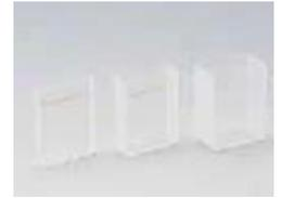
Placa de Calibração do Zero de Transmittância CM-100
