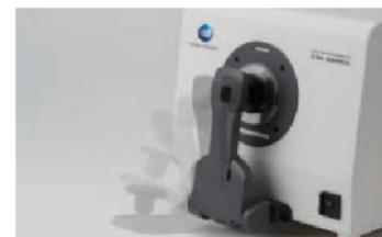
O suporte abre 90° para facilitar o posicionamento de amostras espessas e está equipado com um mecanismo de retorno suave que o impede de fechar bruscamente evitando eventuais danos às amostras.
