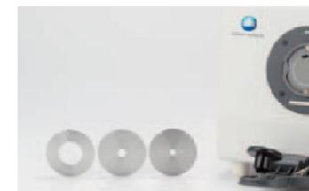
O CM-3600A é fornecido com três máscaras de medição com áreas de (SAV: Ø4 mm, MAV: Ø8 mm e LAV: Ø25,4 mm) para que você possa escolher aquela que melhor se adapta às suas necessidades de medição.
